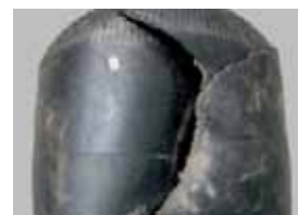
Fig. 4: Soffietto della molla pneumatica di imitazione scoppiato
