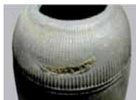
Fig. 3: Soffietto della molla pneumatica logorato
